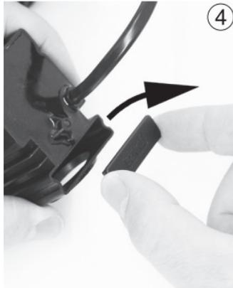
拆下電機蓋 (4) 並沖洗泵腔。如果轉子由於進灰而不能轉動，請不要用力扯出而是用稀釋的乙酸或檸檬酸浸泡泵和轉子約24小時，然後徹底沖洗。
