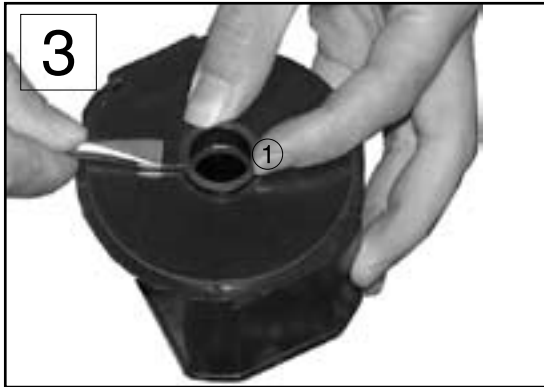
Bild 3 Lagerbuchse (1) im Reparaturfall mit Schraubendreher heraushebeln.
