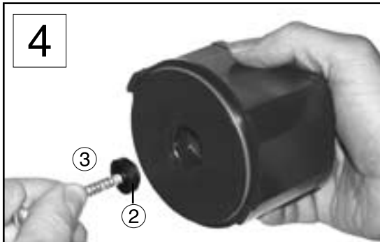
Bild 4 Inneres Rotorlager (2) im Reparaturfall am besten mit einer Holzschraube 4,5x60mm (3) oder einem Drahthaken herausziehen.
